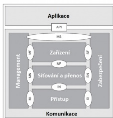
Obrázek 2 normy – Architektura ITS stanice
