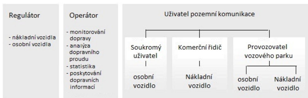
Obrázek 1 – Klasifikace ITS aplikací sídlících v OBE podle typu uživatele (obrázek 2 normy)
