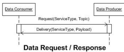
Obrázek 2 - Znázornění jednoduché interakce mezi klientem ( Data Consumer ) a serverem ( Data Producer ) na základě požadavku ( Request ) na doručení odpovědi ( Delivery )
