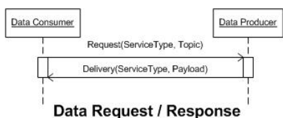
Obrázek 2 - Znázornění jednoduché interakce mezi klientem ( Data Consumer ) a serverem ( Data Producer ) na základě požadavku ( Request ) na doručení odpovědi ( Delivery )
