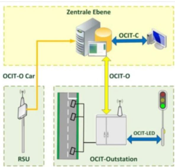
Obrázek 3 – Obecná architektura OCIT (obr. B.1 normy)
