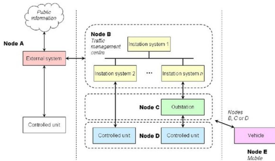
Obrázek 4 – UTMC model uzlových bodů (obr. C.2 normy)
