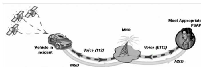
Obrázek 2 - Přehled systému eCall
