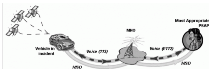
Obrázek 2 - Přehled systému eCall
