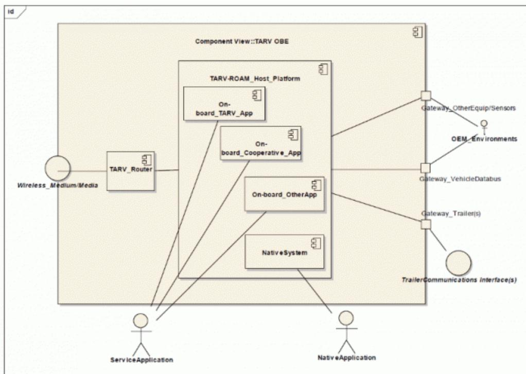
Obrázek 2 – Rozklad komponent [IVS](#) pro TARV (Obrázek 4 normy)
