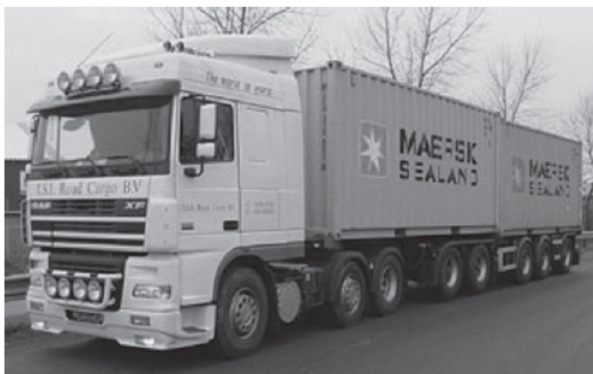
Obrázek 2: Příklady tahače a dvou ISO kontejnerů (dle schématu na obrázku 1 výše) (Obrázek 6 normy)
