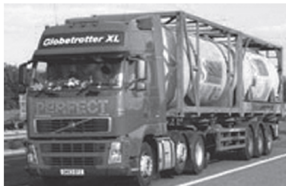
Obrázek 2: Příklady tahače a dvou ISO kontejnerů (dle schématu na obrázku 1 výše) (Obrázek 6 normy)
