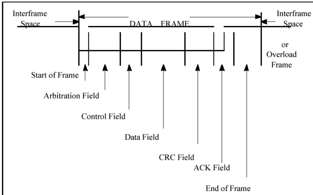
Obrázek 1 – Složení datového rámce (není uveden v normě)
