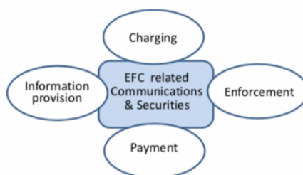
Obrázek 2 – Model EFC systému (obrázek 2 normy)
