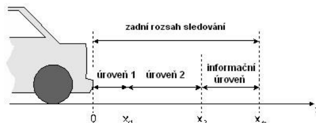
Obrázek 3 – Úrovně varování pro zadní sledovanou oblast
