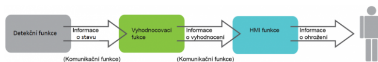
Obrázek 1 - Funkční prvky varovného systému (obr. 1 normy)
