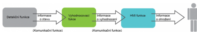
Obrázek 1 - Funkční prvky varovného systému (obr. 1 normy)
