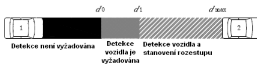
Obrázek 3 - Rozsah detekce (1 - předmětné vozidlo , 2 - cílové vozidlo)
