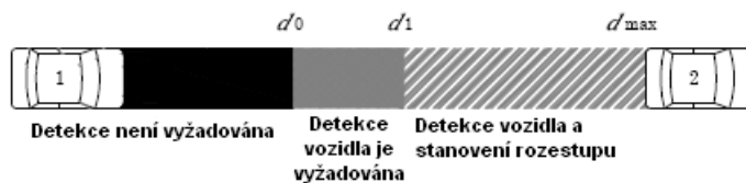
Obrázek 3 – Rozsah detekce (1 – předmětné vozidlo , 2 – cílové vozidlo)
