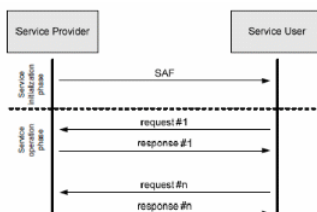
Obrázek 15 - Scénář znázorňující inicializační fázi (bez reakce uživatele) a fázi samotného přenosu dat
