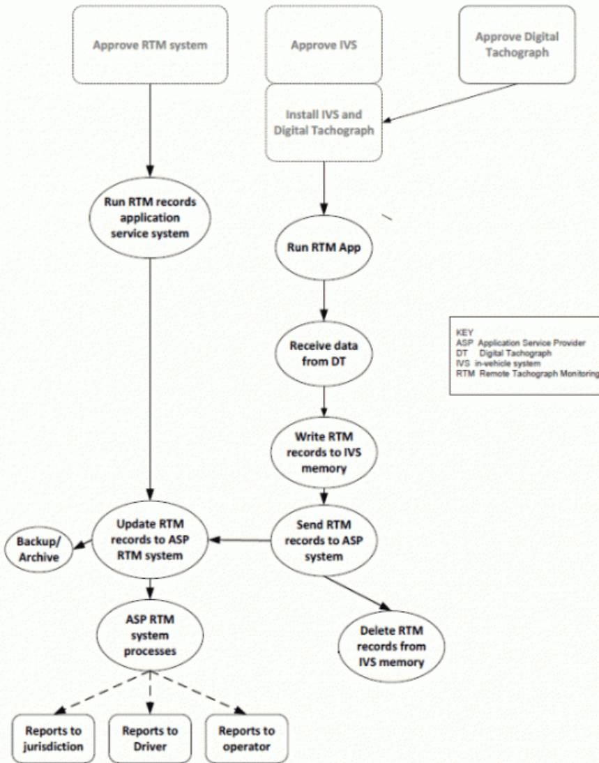
Obrázek 1 – Procesní diagram TARV **RTM** (Obrázek 9 normy)
