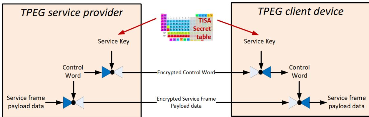
Obrázek 1 - princip šifrování v režimu 1 (obrázek 1 normy)
