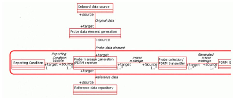
V normě jsou detailně popsány jednotlivé části **procesu**, od sběru „surové“ informace ze senzoru, generování zprávy do jednotného rámce a odeslání do centra.
